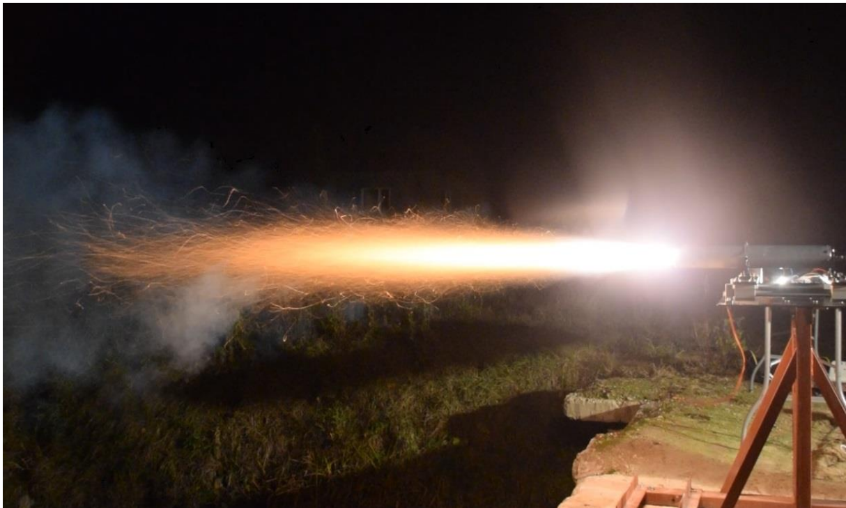
Rysunek 1.. Hybrydowy silnik rakietowy podczas testów w ramach pracy KNN MELprop
